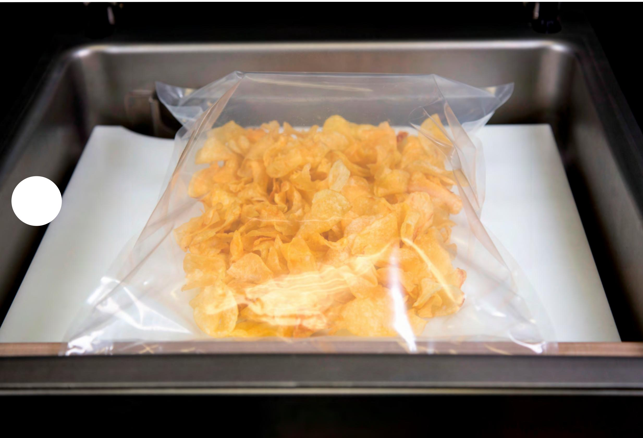
L'installation du système d'injection de gaz inerte est optionnelle sur tous les modèles. Cette fonction permet d'emballer avec une atmosphère protectrice. Selon le gaz utilisé et le produit à conditionner, une amélioration dans la conservation du produit et dans son aspect est obtenue, ou les dommages en cas de produits fragiles sont évités.
